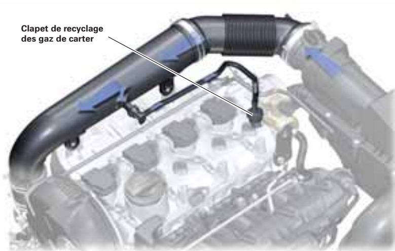
Coupe du clapet de recyclage des gaz de carter
