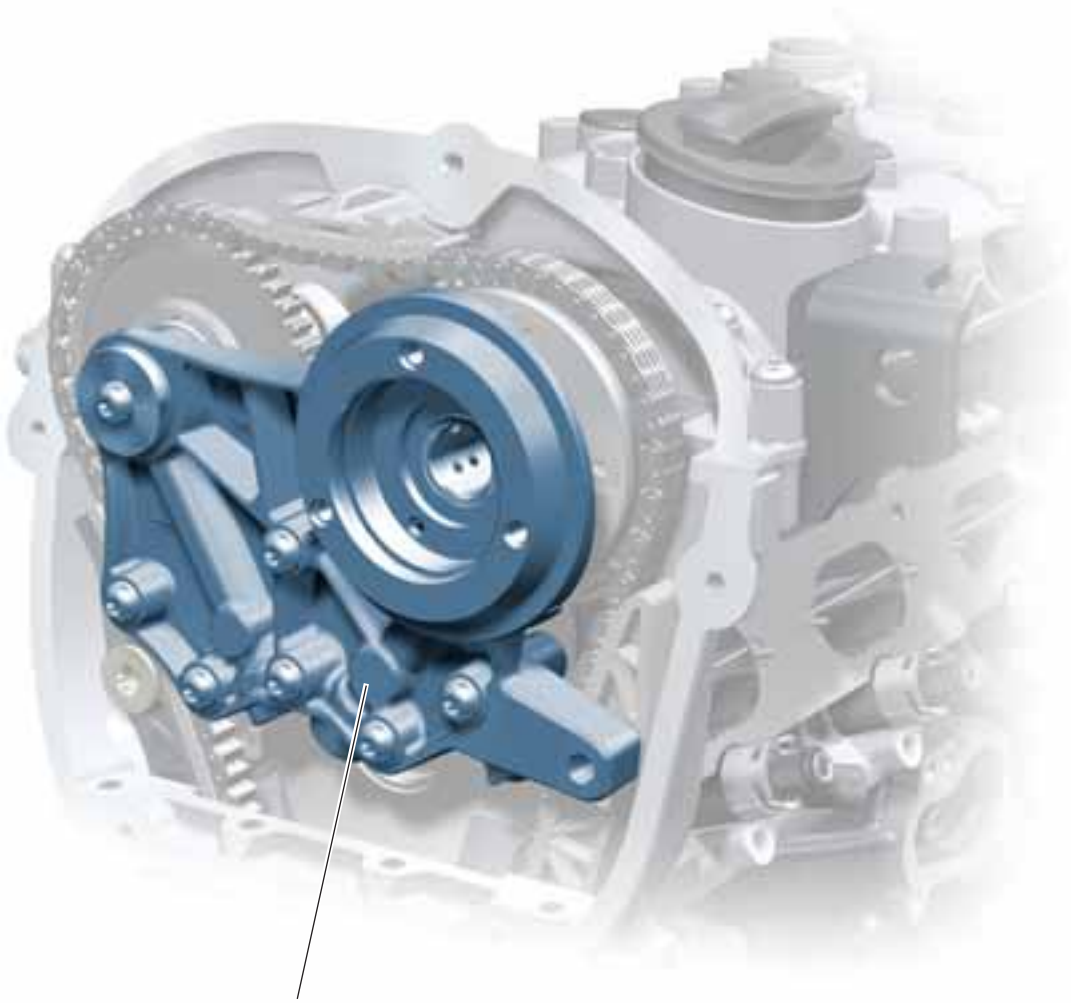
Rampe de paliers
