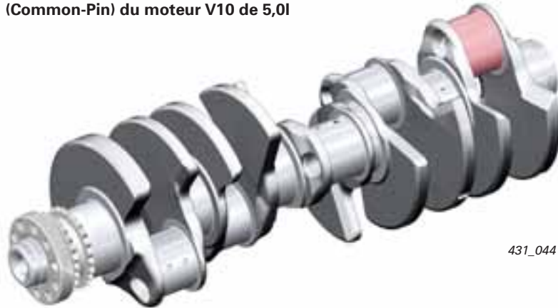
Vilebrequin avec maneton commun (Common-Pin) du moteur V10 de 5,0l
