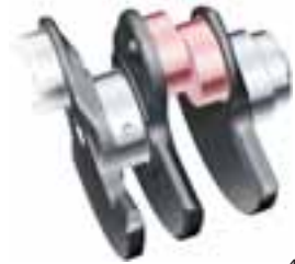
Pour comparaison, maneton fendu (split-pin) du moteur V10 de 5,2l
