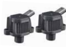
Actionneurs de cames d'admission pour les cylindres 2 et 3 N583, N591.
