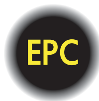
Témoin de défaut de la commande d'accélérateur électrique, K132
