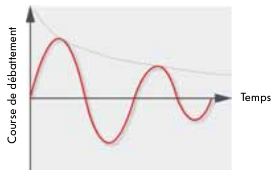
Faible niveau d'amortissement
